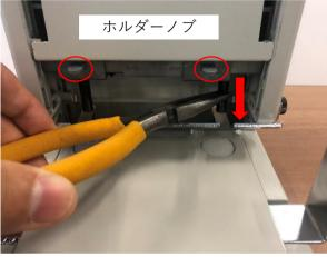
注意:取り出すときにうまく外れない場合は替刃の 胴部に手を添えて真下に下ろしてから手前方向に引き 出します。
