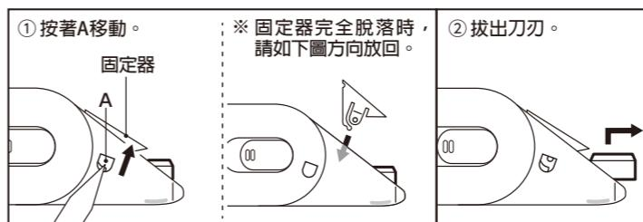
① 以尖端細的物品，按著 A，將固定器往箭頭方向移動。
