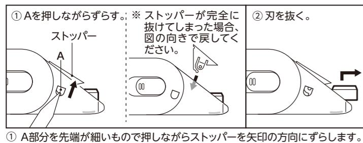
① A部分を先端が細いもので押しながらストッパーを矢印の方向にずらします。
