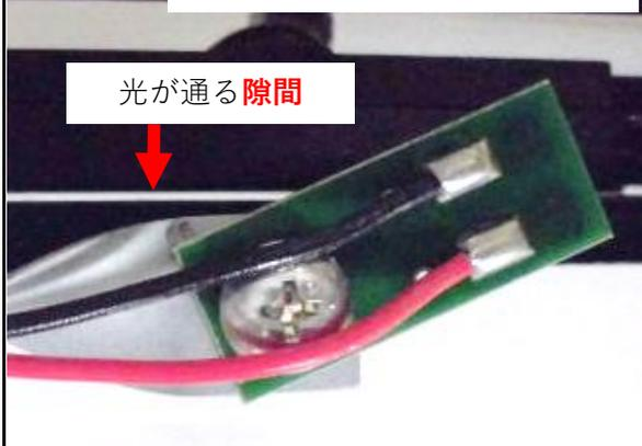
カットラインは刃の上方に設置されたLEDランプの光が刃と紙押えの隙間を通して紙面に照射されて表示します。
